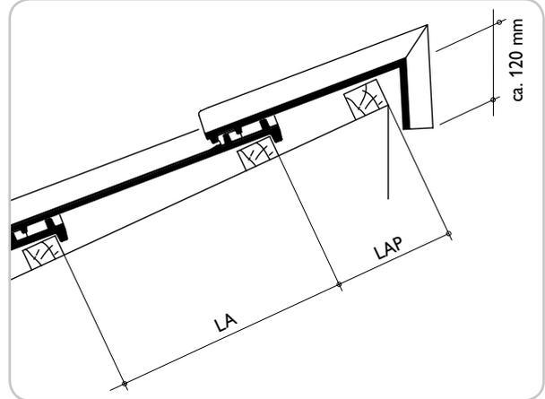
Die Pultziegel werden bauvorhabenspezifisch hergestellt. Um aufwändige Sondergrößen zu vermeiden, ist der Lattenabstand Pult (LAP) aus nachstehender Tabelle zu berücksichtigen.
