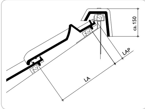
Der Lattenabstand Pult (LAP) dient der Orientierung für
