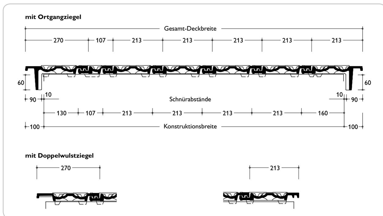
Konstruktionsbreite = jeweils Schnürabstand Ortgang rechts + Dachziegel + Halber Dachziegel + Ortgang links
