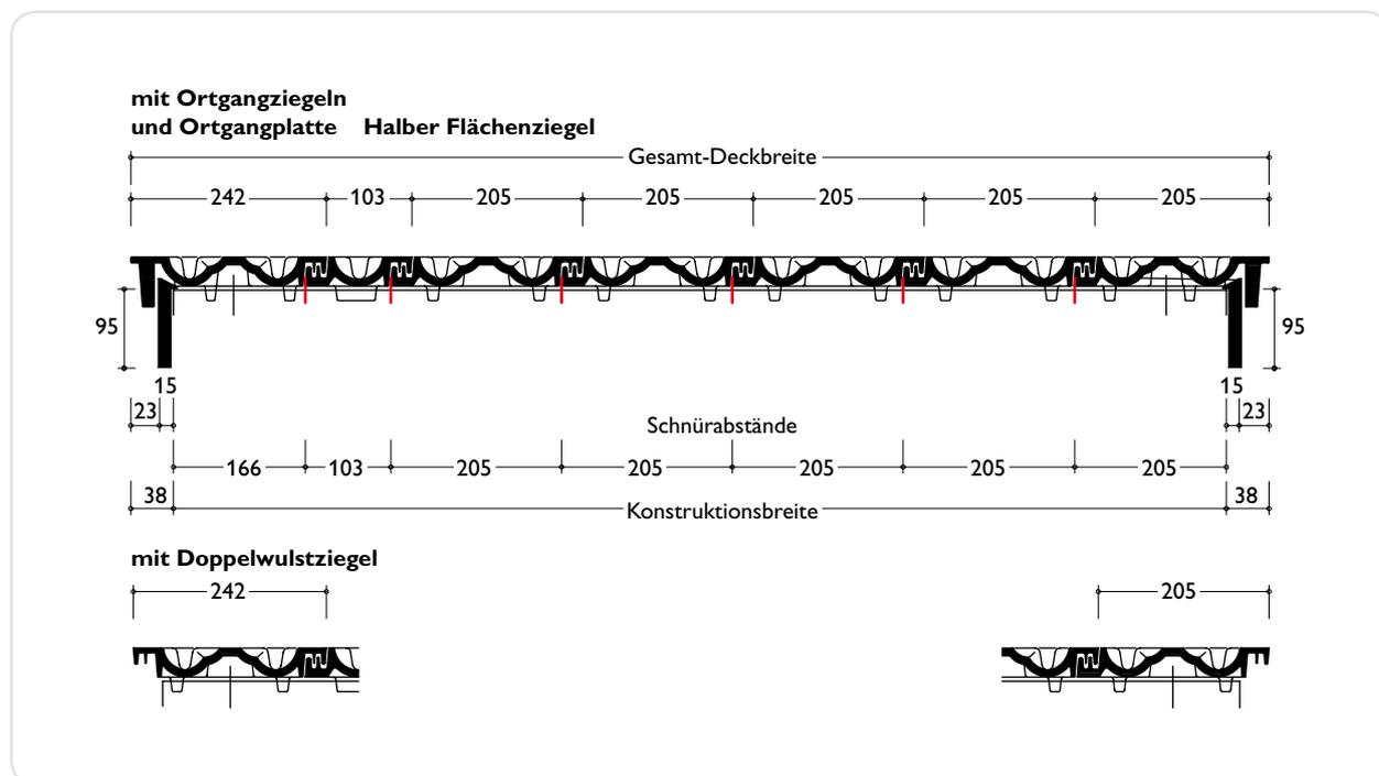
Konstruktionsbreite = jeweils Schnürabstand Ortgang rechts + Dachziegel + Ortgang links
