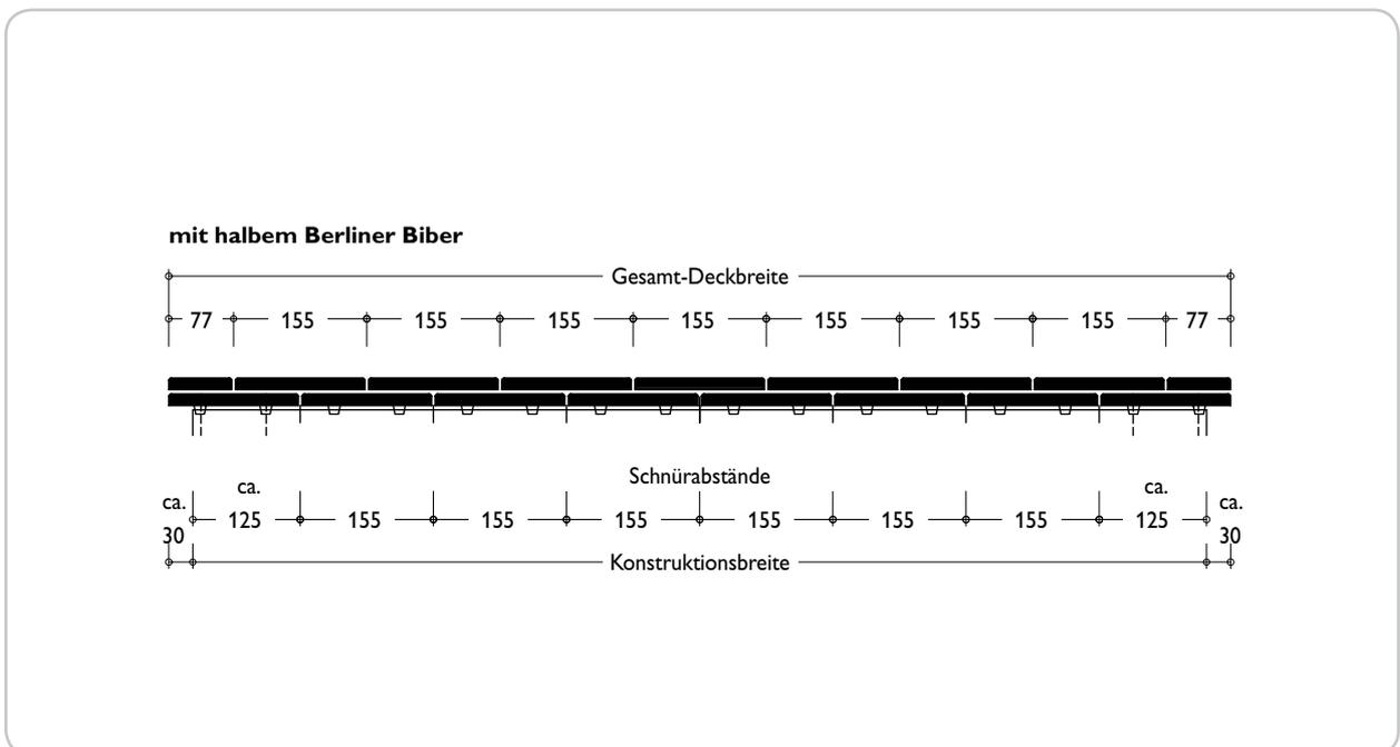
Konstruktionsbreite = jeweils Schnürabstand Ortgang rechts + Dachziegel + Ortgang links
