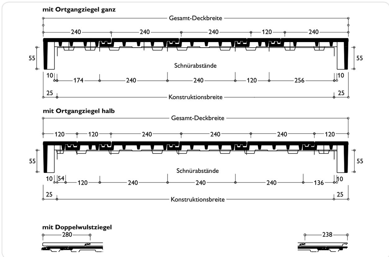
Konstruktionsbreite = jeweils Schnürabstand ganzer Ortgang rechts + Dachziegel + ganzer Ortgang links
