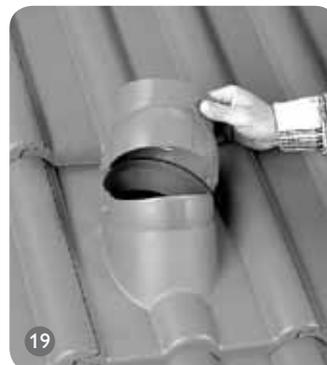
Die DuroVent Abgaskalotte ist für die Durchführung der Abgasdoppelrohre von Gasthermen und Brennwertgeräten vorgesehen, deren Innenrohr außen nicht wärmer als +85 °C wird. Folgende Modelle stehen zur Verfügung:
