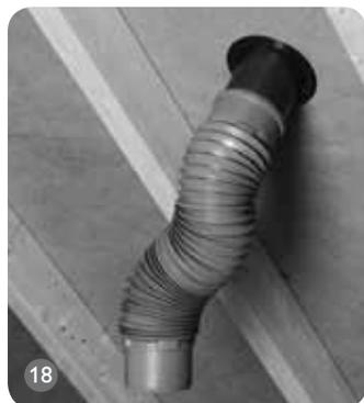
Für den variablen Anschluss an die Lüftungsleitung ist der Flexible Schlauchanschluss in DN 125 oder DN 100 erhältlich. Auch der direkte Anschluss von HT-/KG-Rohren und -Bögen ist möglich.
