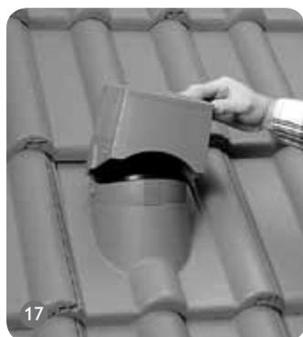
Das System besteht aus der Durchgangspfanne mit Anschlussrohr. Das Anschlussrohr steht wahlweise in DN 125 oder DN 100 zur Verfügung. Auf die Durchgangspfanne wird das Oberrohr oder der Sanilüfter (Foto) aufgesetzt. Der Sanilüfter ist dachneigungsunabhängig, das Oberrohr lässt sich bei Dachneigungen von 15° bis 55° senkrecht ausrichten. Beide Systeme sind mit Öffnungen für Kondensatablauf ausgerüstet.
